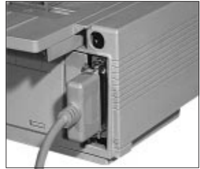
Paralleles Schnittstellenkabel und Anschluß
