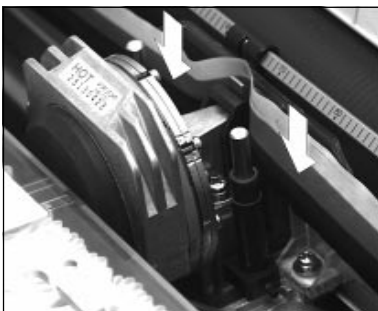
Einlegen des Farbbandes beim Farbdrucker
