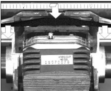
Einlegen des Farbbandes beim Standarddrucker
