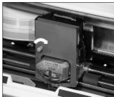
Farbband über den Druckkopf nach hinten drücken.
