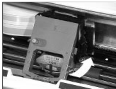
Farbband über den Druckkopf nach hinten drücken.
