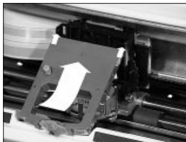
Farbband hier einsetzen.
