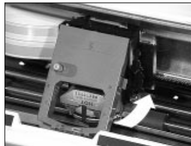
Farbband über den Druckkopf nach hinten drücken.
