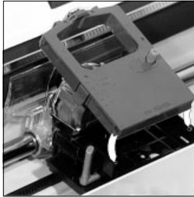
Farbband hier einsetzen
