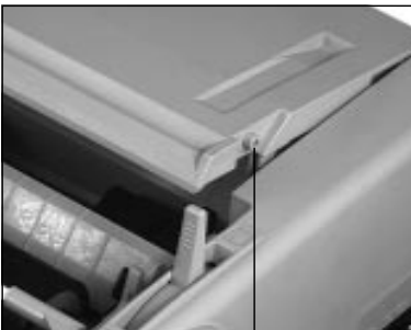
Stift an der Druckerabdeckung
