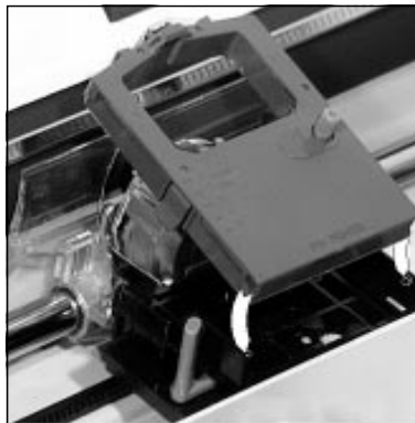
Farbband hier einsetzen
